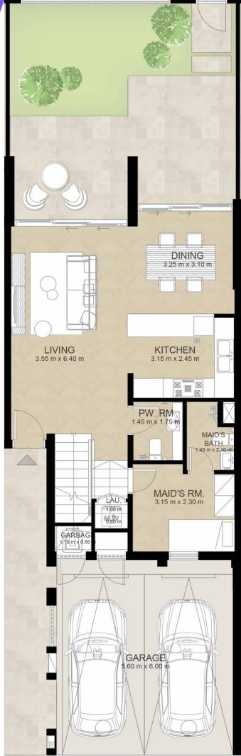
GROUND LEVEL الطابق الأرضي
